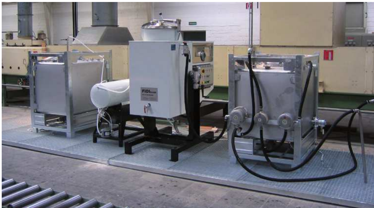
Kombinace destilačního zařízení s nádržemi pro znečištěné a čisté rozpouštědlo
